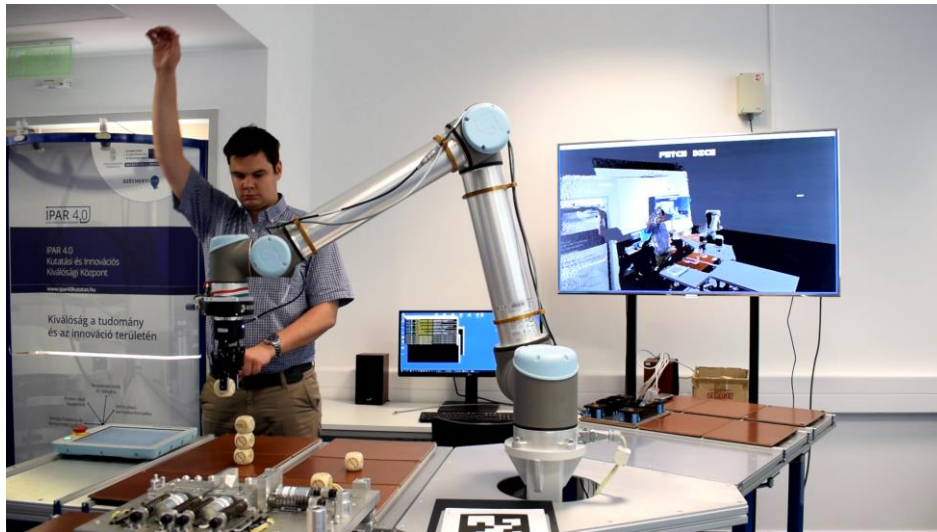
Robot vezérlése gesztusokkal az MTA SZTAKI győri Ipar4.0 mintarendszerében
